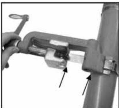
Band in Schlitz der Werkzeugnase und Spalt einführen. Daumen auf den Festhaltehebel drücken. Spannung entsteht durch Drehen am Handhebel.
