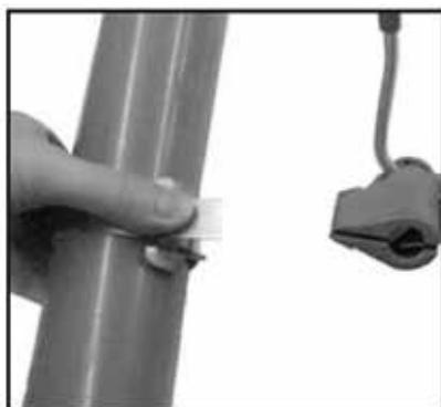
Werkzeug entfernen. Endstück des Stahlbandes mit Daumen festhalten.
