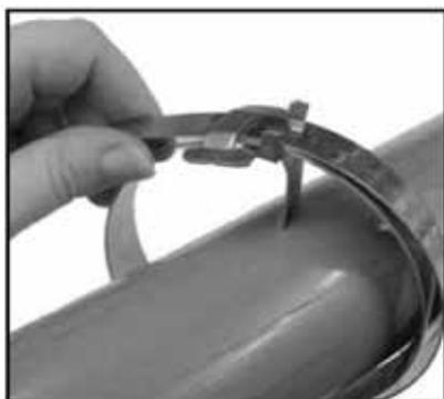
Für eine Doppelbindung das Band nochmals um das Objekt und durch die Schlaufe ziehen. Das freie Ende des Bandes unter die Schlaufe biegen. Eine Doppelbindung erreicht fast die vierfache Radialkompression einer einfachen Bindung.
