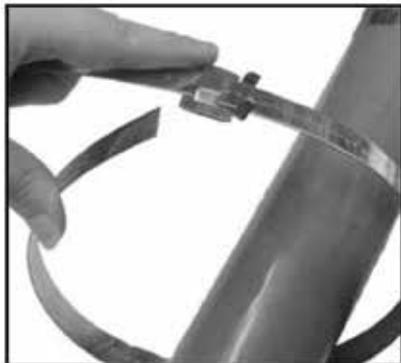
Das Band kann direkt von der Rolle genutzt werden, werden, wodurch eine Verschwendung des Bandes verhindert wird. Schieben Sie die Schlaufe, wie abgebildet, auf das Band, legen Sie das Band um das Objekt herum und führen Sie das Ende in die Schlaufe ein.
