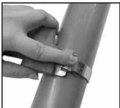
Nachdem die Spannung erreicht ist, Festhaltehebel loslassen, da er sich unter Spannung selbst schließt.
