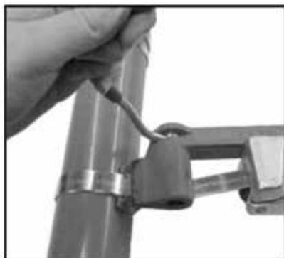
Schneidhebel herunterziehen. Dadurch wird das Stahlband genau auf Maß abgeschnitten.
