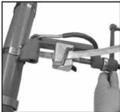
Werkzeug von sich weg drehen und gleichzeitig Handhebel lösen. Wenn der Handhebel beim Wegdrehen des Werkzeuges nicht gleichzeitig gelöst wird, kann das Stahlband abreißen. Die Spannung geht nicht verloren, da Wegdrehen des Werkzeuges die Spannung erhält.
