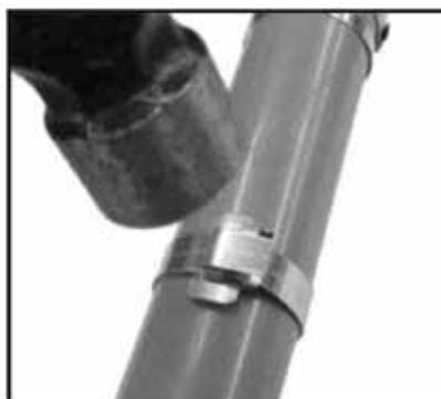
Ohren der Schlaufe Umschlagen und festhämmern. Die Spannschlaufe ist fertig.
